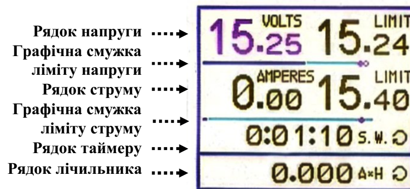
Мал. 3. Відображення інформації на дисплеї джерела живлення
