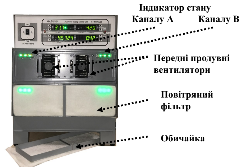
Мал. 5. Зовнішній вигляд випрямляча з двома силовими модулями (верхній модуль зі знятим фільтром)
