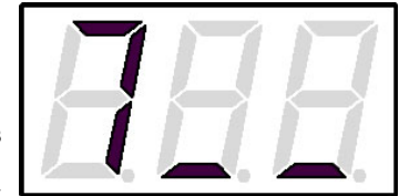
Мал. 9. Символ таймеру (дозатору) з вимкненням струму
