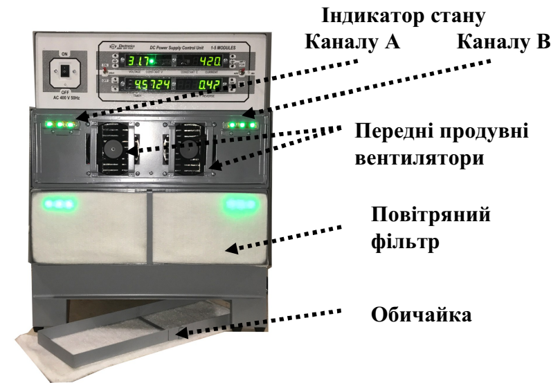
Мал. 5. Зовнішній вигляд випрямляча з двома силовими модулями (верхній модуль зі знятим фільтром)
