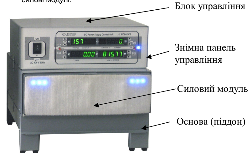
Мал. 2. Складові частини випрямляча
