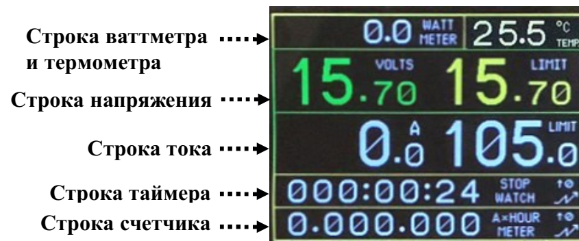
Рис. 3. Отображение информации на дисплее источника питания
