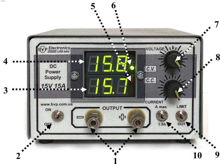
Мал. 2. Розташування органів управління на передній панелі джерела живлення
