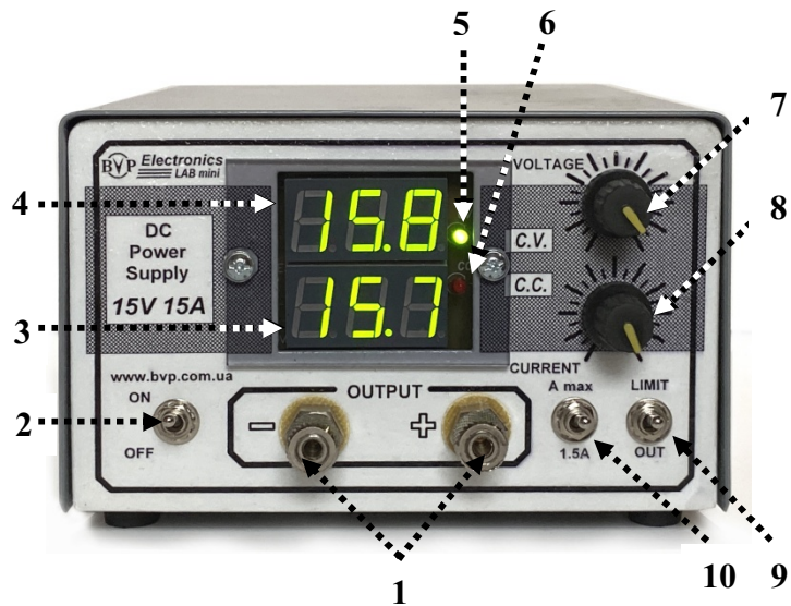
Мал. 2. Розташування органів управління на передній панелі джерела живлення
