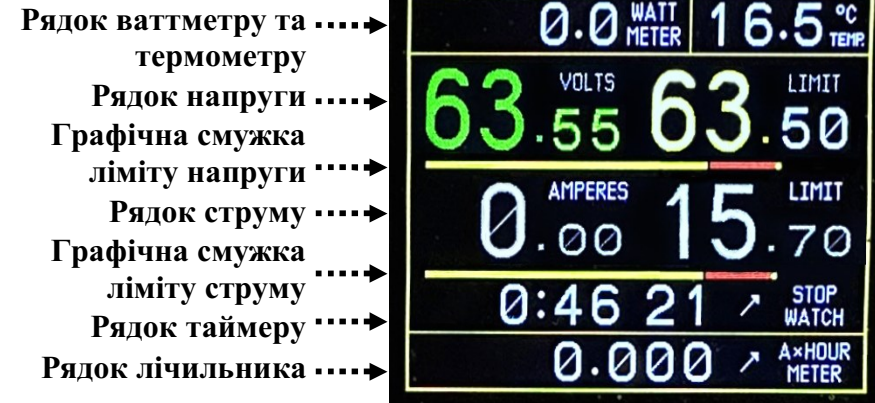
Мал. 3. Відображення інформації на дисплеї джерела живлення
