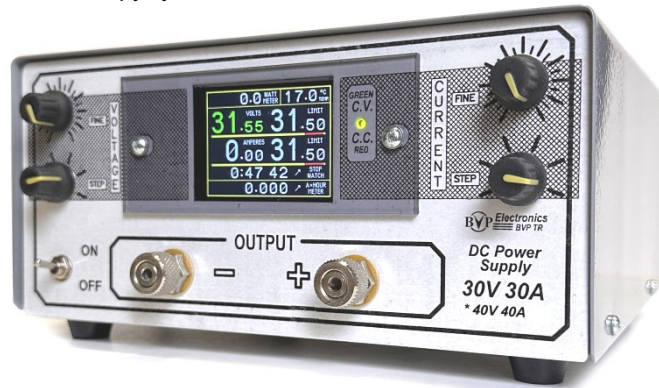
Мал. 1. Імпульсне джерело живлення постійного струму BVP TR 30V 30A
