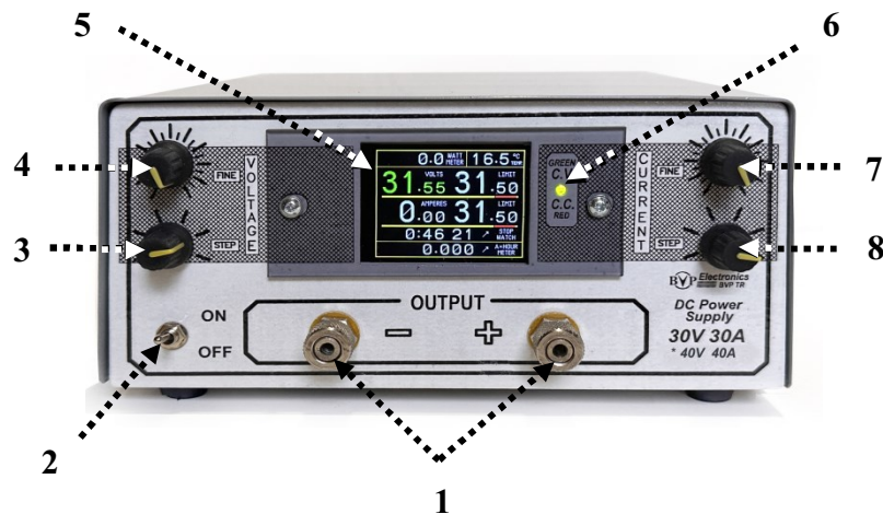
Мал. 2. Розташування органів управління на передній панелі джерела живлення
