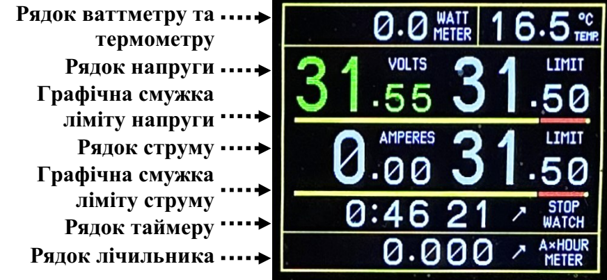
Мал. 3. Відображення інформації на дисплеї джерела живлення
