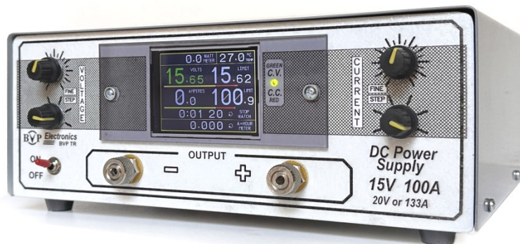
Мал. 1. Імпульсне джерело живлення постійного струму VVP TR 15V 100A
