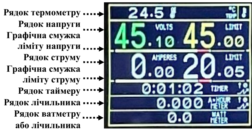
Мал. 3. Відображення інформації на дисплеї джерела живлення
