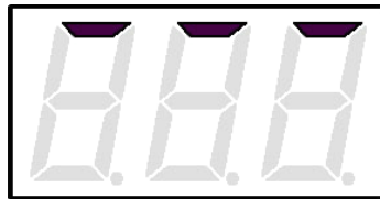
Мал. 11. Символ таймеру (дозатору) без вимкнення струму
