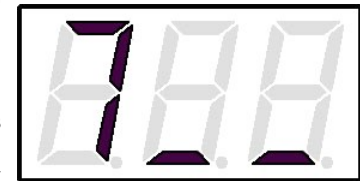
Мал. 9. Символ таймеру (дозатора) з відключенням струму
