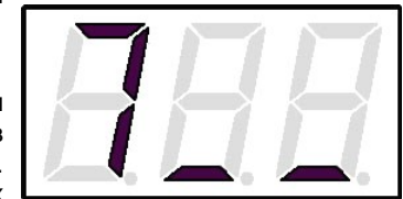
Мал. 9. Символ таймеру (дозатора) з відключенням струму
