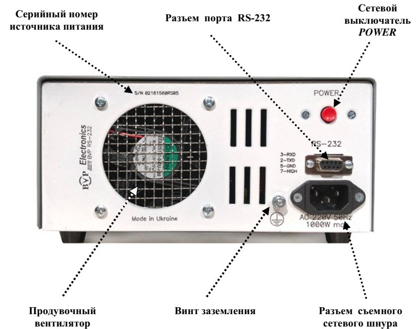
Рис. 3. Расположение органов управления на задней панели источника питания
