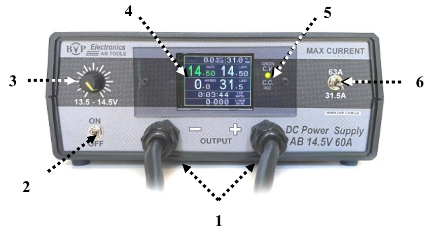
Мал. 2. Розташування органів управління на передній панелі джерела живлення
