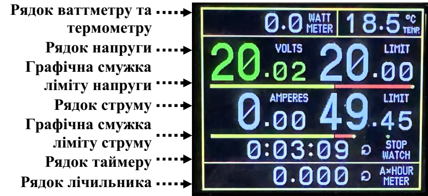
Мал. 3. Відображення інформації на дисплеї джерела живлення
