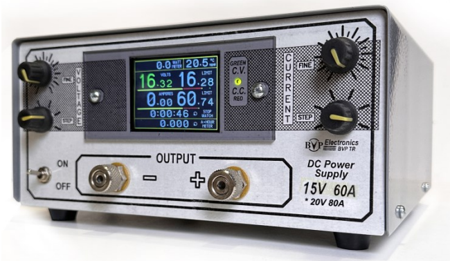
Мал. 1. Імпульсне джерело живлення постійного струму BVP TR 15V 60A
