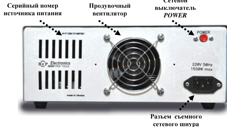
Рис. 5 Расположение органов управления на задней панели управляемого модуля источника питания
