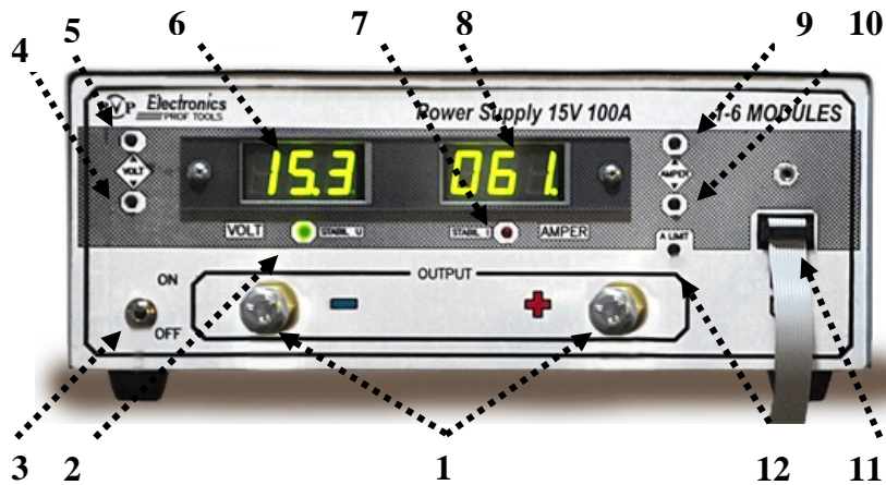
Рис. 2. Расположение органов управления на передней панели головного модуля источника питания
