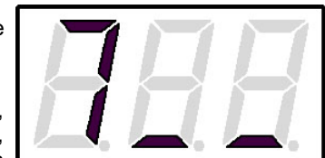
Рис. 8. Символ таймера (дозатора) с отключением тока
