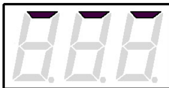
Рис. 10. Символ таймера (дозатора) без отключения тока
