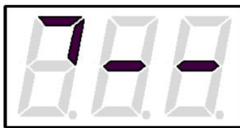
Рис. 9. Символ таймера (дозатора) снижения лимита тока до 10%
