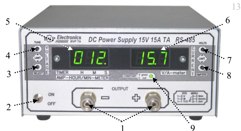
Рис. 2. Расположение органов управления на передней панели источника питания
