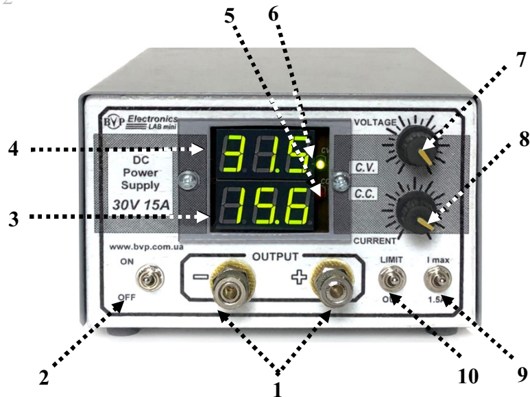
Рис. 2. Расположение органов управления на передней панели источника питания
